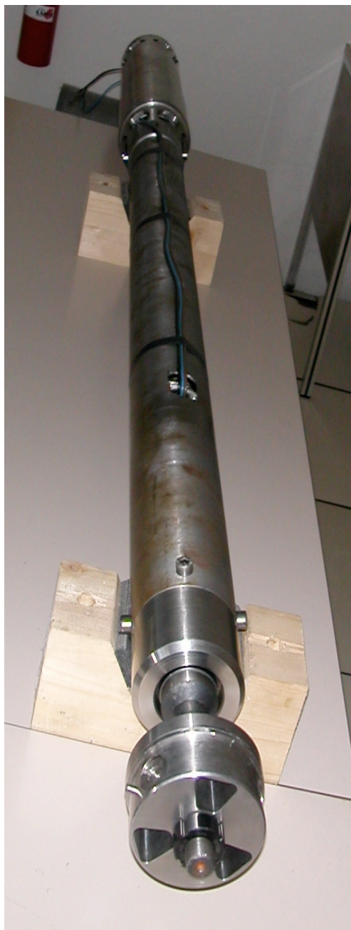
Fig. 9 - Foto dell'insieme motore-alberi-trasmissione-attacchi del carotiere.
