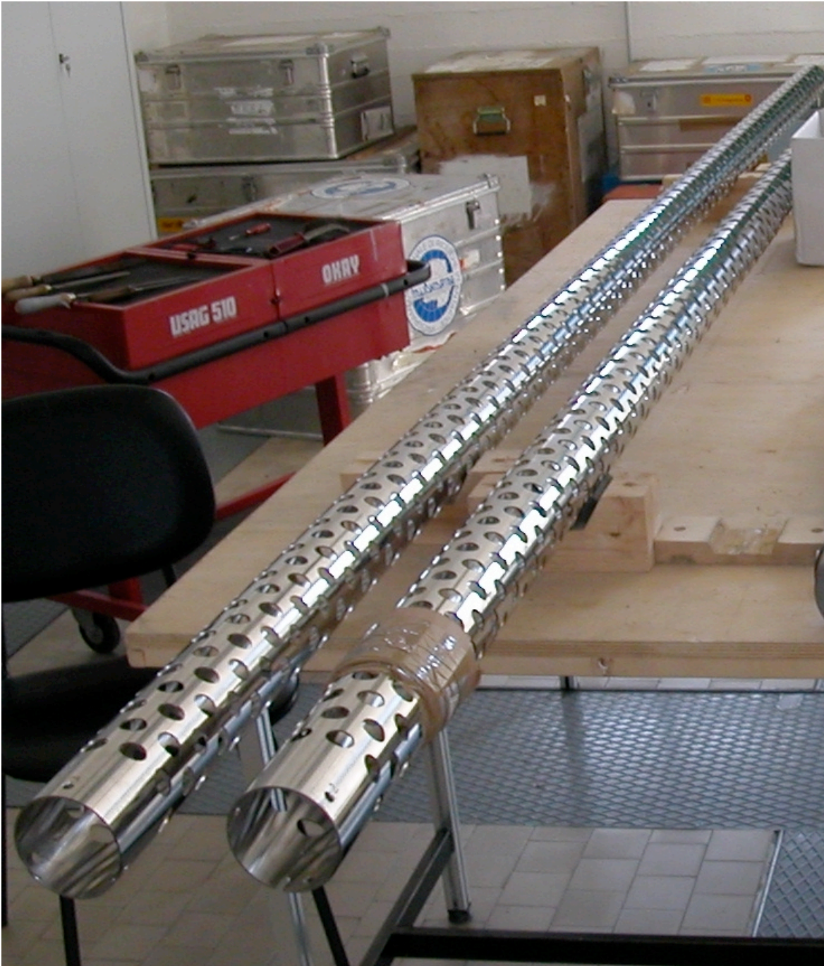
Fig. 6 - Tubi portafiltri per la separazione dei chips dal liquido.
